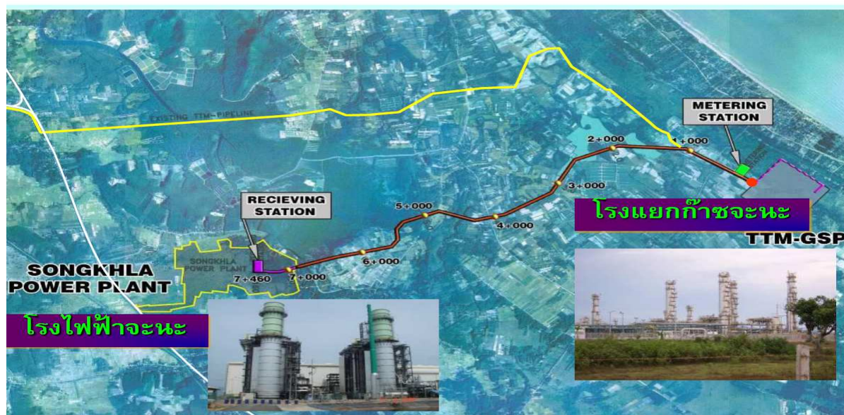
ภาพที่ 5 : แสดงโรงแยกก๊าซจะนะ ที่มีท่อส่งก๊าซ (สีแดง) มายังโรงไฟฟ้าจะนะ เหตุที่ท่อส่งก๊าซคดเคี้ยวเหมือนงูเลื้อยก็เพราะชาวบ้านบางส่วนไม่ยอมขายที่ดินให้ท่อผ่าน
